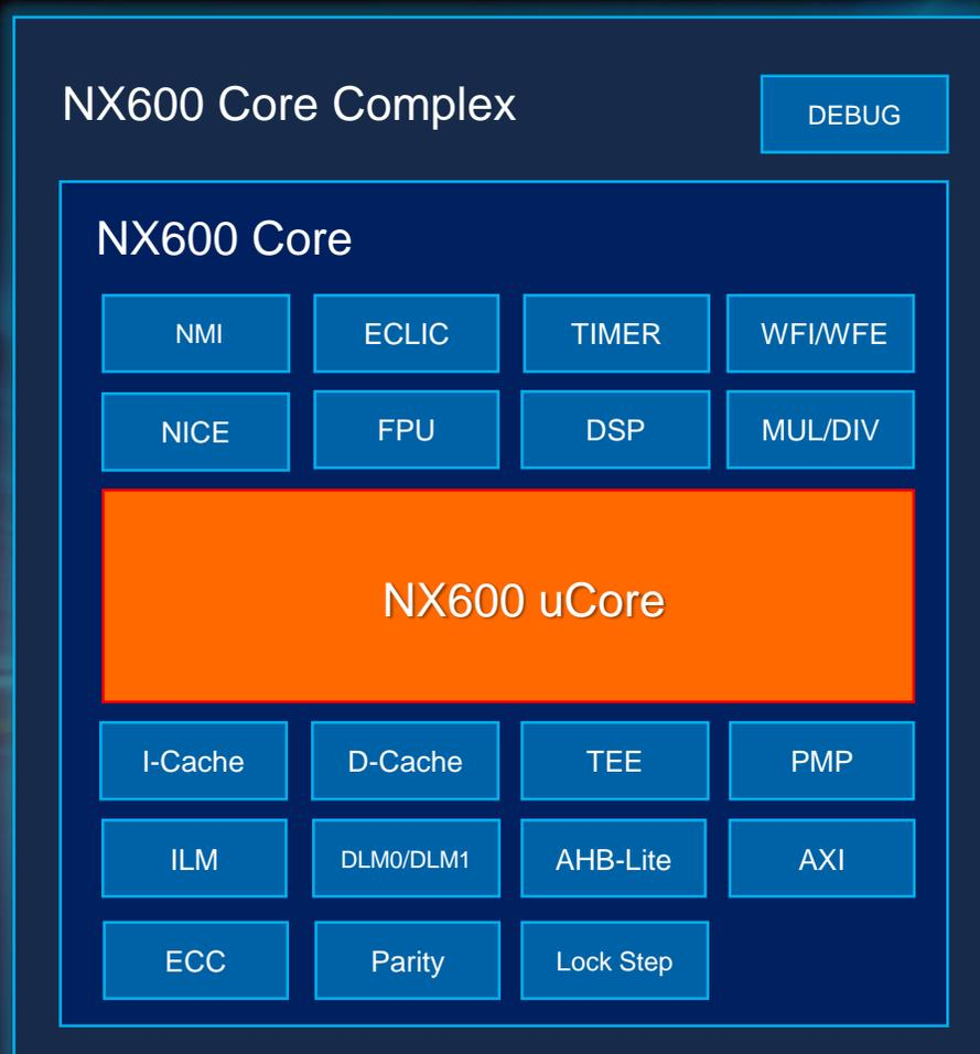
NX600系列64位RISC-V处理器面向实时控制或高性能嵌入式应用场景，非常适合对标ARM Cortex-M7, R4, R5, R7等内核，应用于AIoT边缘计算，存储或其他实时控制应用。
